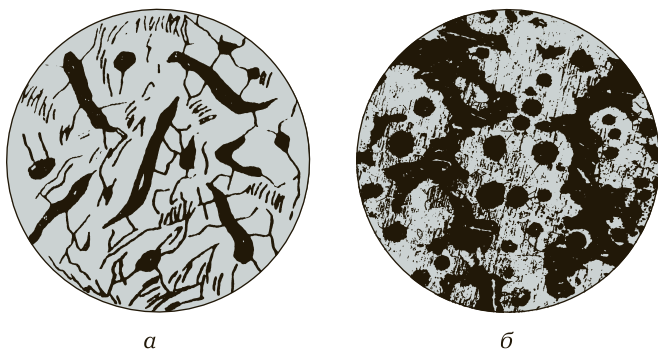
Рис. 4.5. Микроструктура чугуна до модифицирования — перлит (а) и после модифицирования — шаровидный графит (б)
