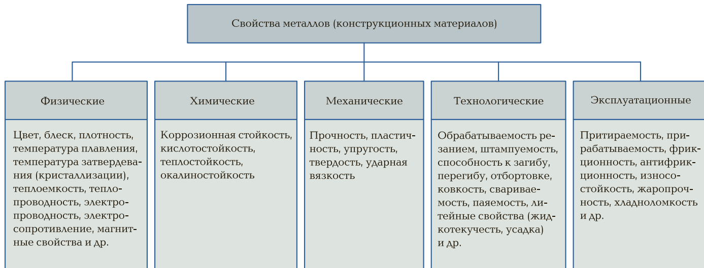
Рис. 2.1. Классификация свойств металлов и сплавов
