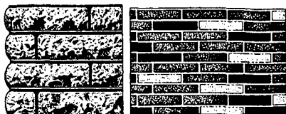
Рис. 62. Виды фактур лицевых граней керамического кирпича
