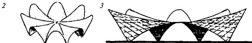
Рис. 116. Покрытия из оболочек типа гиперболического параболоида в Мехико. Архит. Ф. Кандела 1 – часовня; 2, 3 – ресторан
