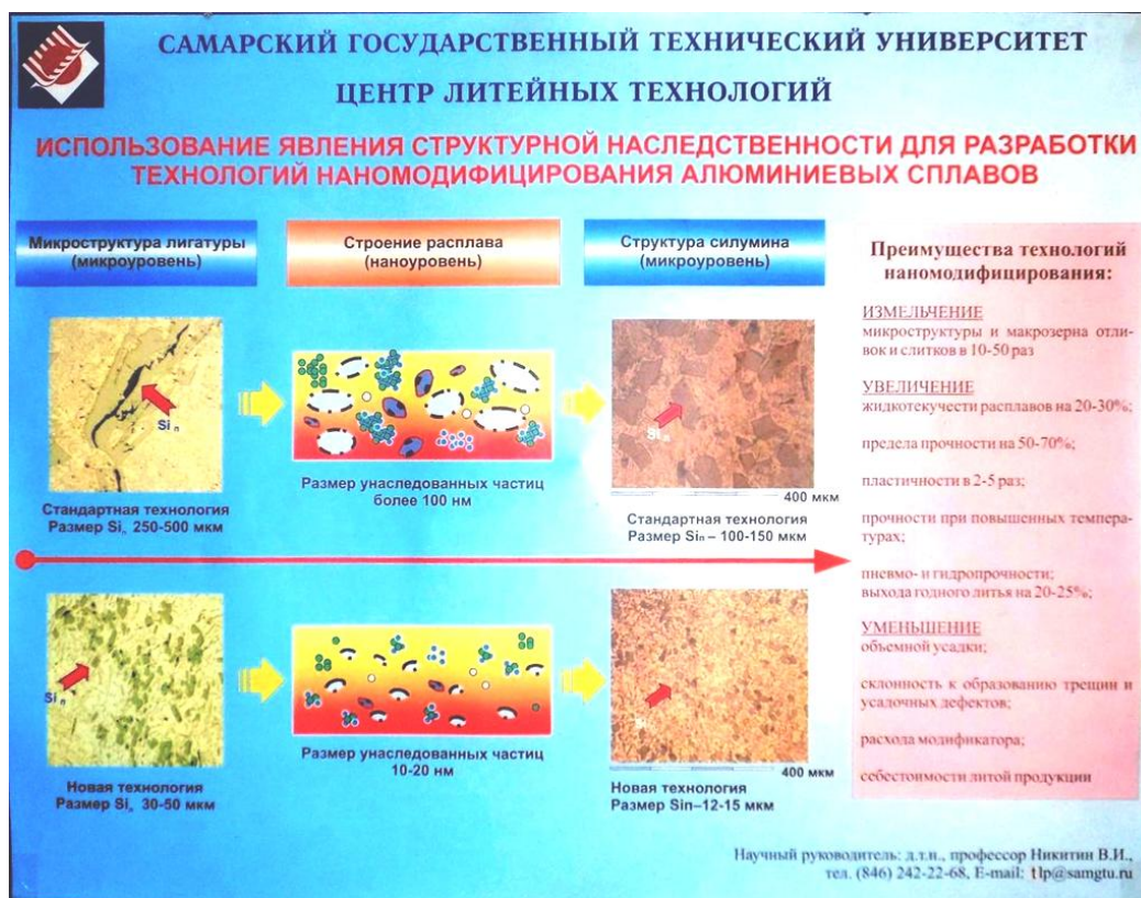
Рис. 64. Генетическая связь структуры ШМ (лигатуры) со структурой расплава и отливки
