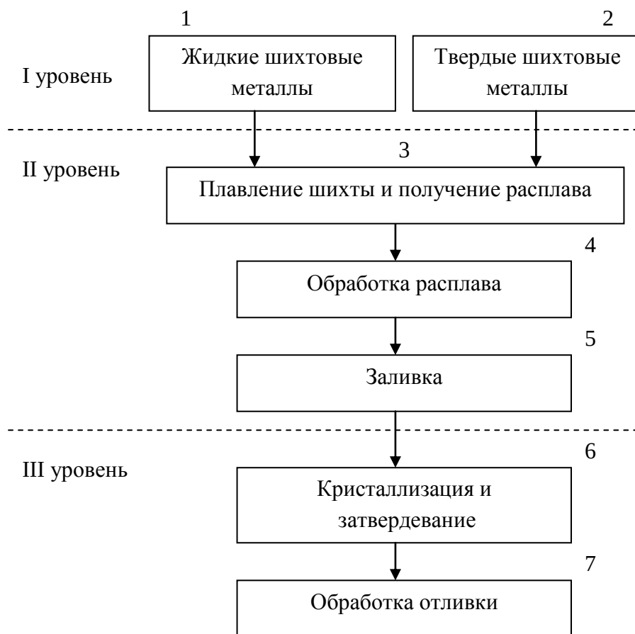
Рис. 16. Схема основных технологических процессов в литых изделиях:
