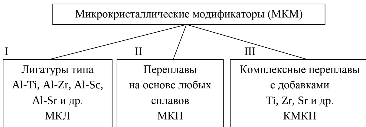
Рис. 42. Классификация МКМ для алюминиевых (и других) сплавов
