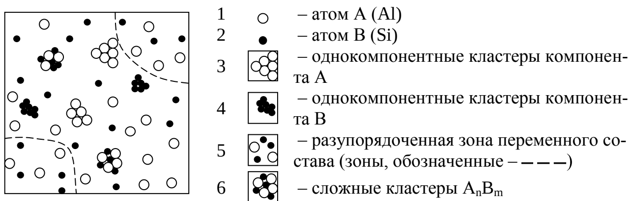
Рис. 5. Схема строения расплава системы А+В (по Новохатскому И.А.)
