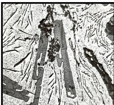
Чушковая \text{AlSr}_{10} Производство ф.LSM Великобритания (размер \text{SrAl}_4=500 \text{ мкм} ) ( N=24 \text{ шт/мм}^2 )
