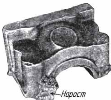
Рис. 17.25. Нарост на чугунной отливке крышки подшипника
