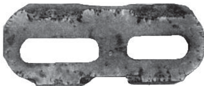
Рис. 17.87. Ситовидные раковины в сечении стальной отливки
