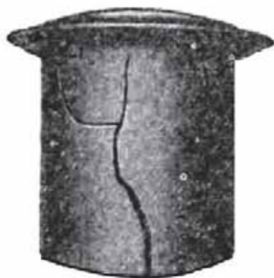
Рис. 17.38. Холодная трещины в отливке при плохой податливости стержня
