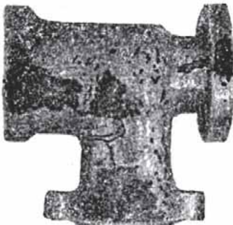
Рис. 17.49. Отливка, пораженная газовыми раковинами
