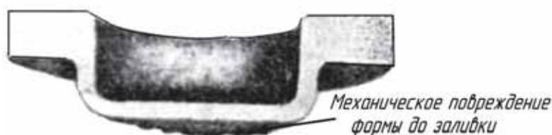
Рис. 17.10. Механическое повреждение формы до заливки.
