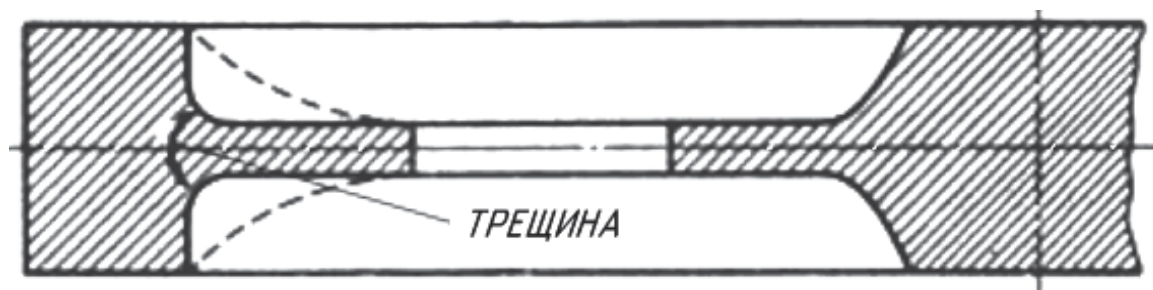
Рис. 15.6. Отливка – неизотермичный жесткий стальной маховик. Пунктиром показана улучшенная конструкция.
