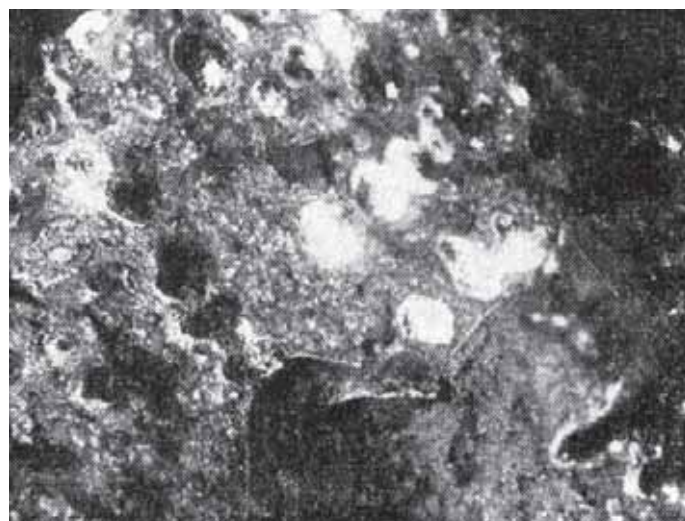
Рис. 17.43. Мелкие и округлые блестящие трещины на поверхностях кристаллов (x 12)
