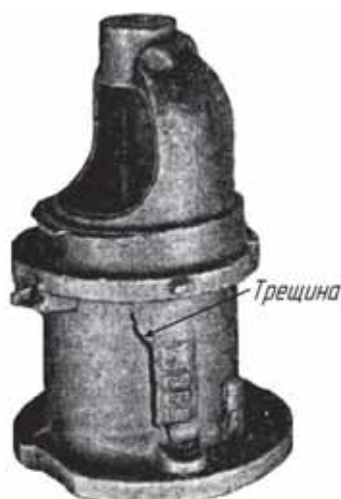
Рис. 17.37. Трещина в стальной отливке
