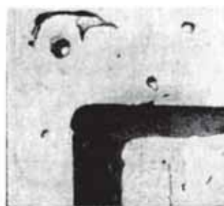
Рис. 17.69. Газовые раковины от брызг металла
