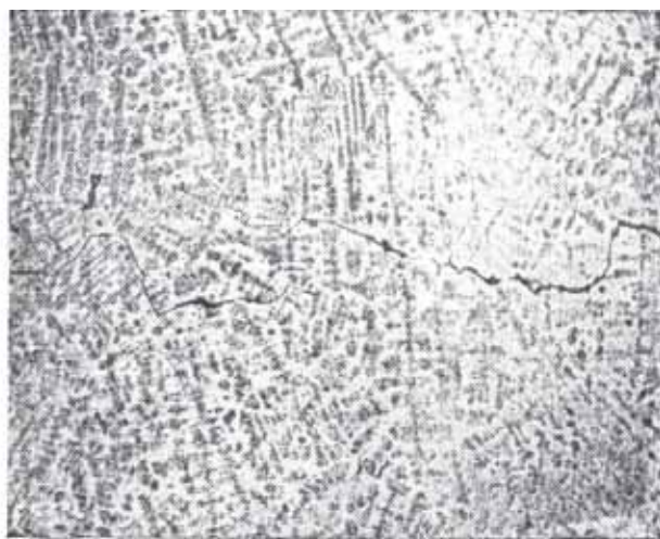
Рис. 17.41. Трещины, располагающиеся между зернами грануляционной структуры, без ориентировки по отношению к дендритам (х 6).
