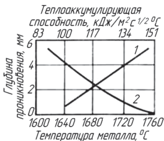
Рис. 14.23. Проникновение жидкого металла в форму в зависимости от температуры его заливки (1) и теплоаккумулирующей способности смеси (2)
