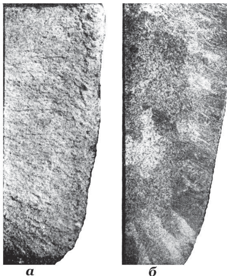
Рис. 17.48. Излом (а) и макрошлиф (б) отливки без трещин (x 0,5)
