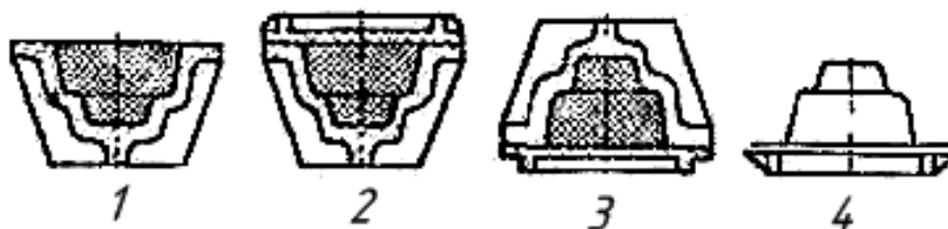
Рис. 8.20. Изготовление целого стержня: 1 – засыпка стержневой смеси в ящик и ее уплотнение; 2 – укладка сушильной плиты; 3 – поворачивание ящика с плитой на 180^\circ и снятие ящика со стержня; 4 – отделка стержня и отправка его в сушило
