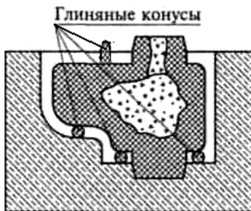
Рис. 9.29. Проверка толщины тела по глиняным конусам («мушкам»)
