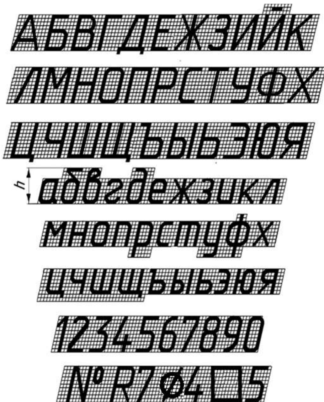
Рис. 4. Чертежный шрифт типа Б с наклоном
