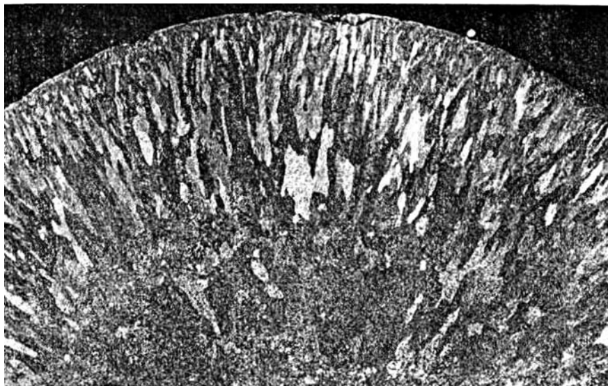
Рис. 5.9. Первичная структура слитка диаметром 130 мм после травления азотной кислотой (Н.И. Хворинов)
