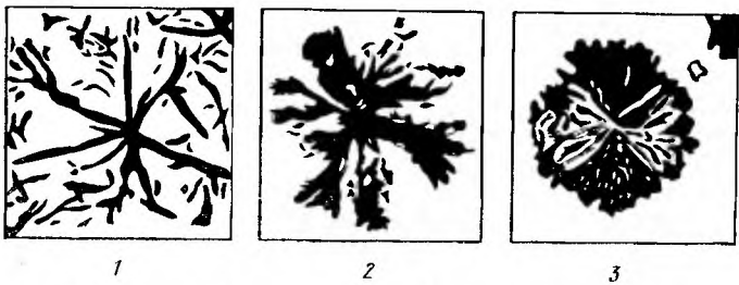
Рис. 5.10. Изменение формы включений первичного графита в сером чугуине при увеличении содержания церия; \times 300
