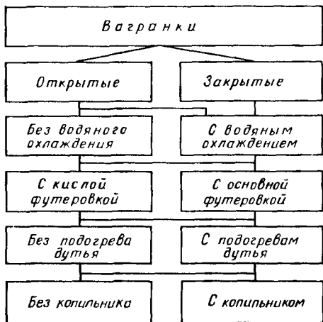
Рис. 10.3. Основные типы современных вагранок
