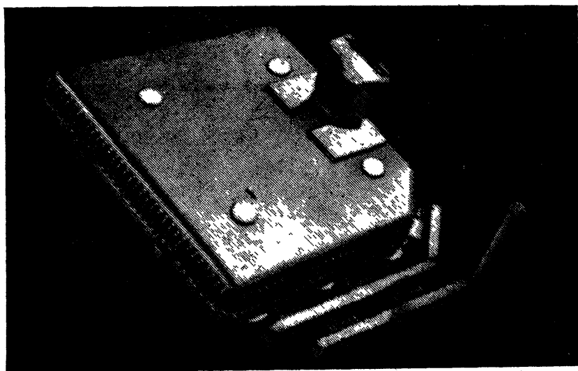
Рис. 99. Крышка из сплава АЛ2 с литниковой системой, не обеспечивающей качество детали (конструкция усовершенствованной литниковой системы показана на рис. 85)
