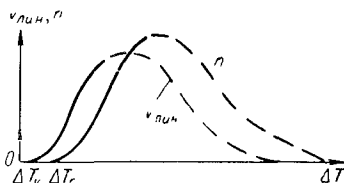
Рис. 8. Скорость образования центров кристаллизации n и линейная скорость кристаллизации v_{\text{линей}} при изменении переохлаждения
