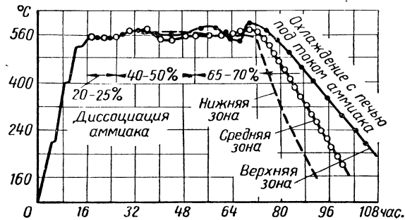
Фиг. 109. Режим азотирования крупных коленчатых валов.
